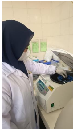
Sentrifuge sampel darah untuk mendapatkan serum
