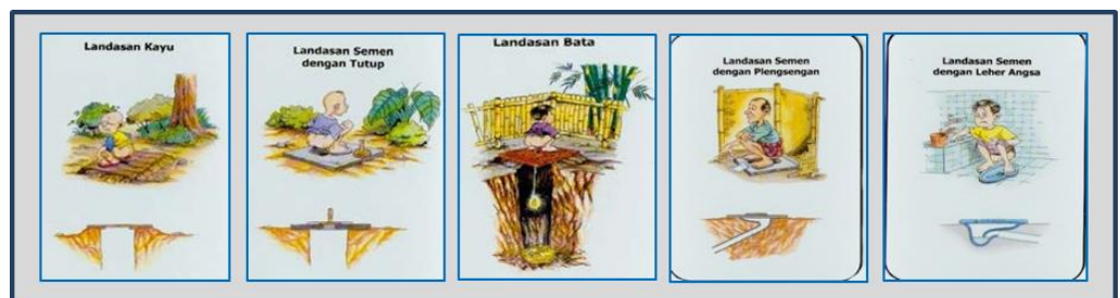
Gambar 3 Bangunan Tengah Jamban
