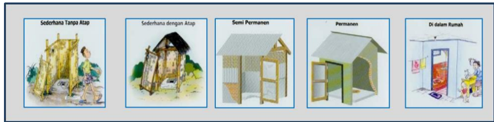
Gambar 2 Bangunan Atas Jamban
