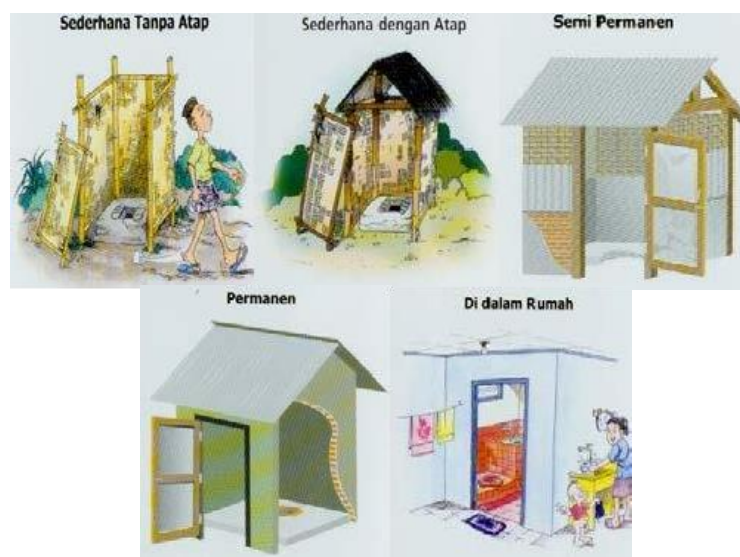
Gambar 2. Bangunan Atas Jamban
