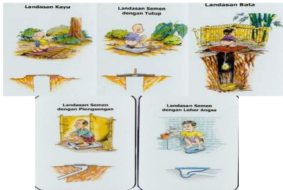
Gambar 3. Bangunan Tengah Jamban
