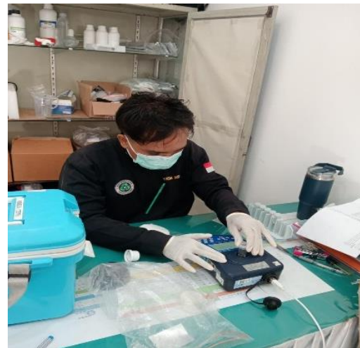
Melakukan pengecekan kualitas fisik kekeruhan dan warna air PAH
