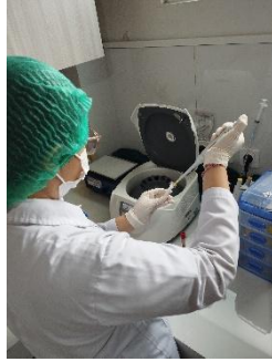
Proses pemipetan sampel sebanyak 200 \mu L serum ke dalam sampel cup yang telah diberi barcode identitas pasien
