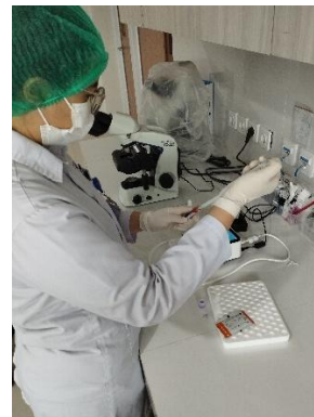
Proses pemipetan sampel sebanyak 15 \mu L ke dalam buffer dan dihomogenkan dengan batang pengaduk sebanyak 5-10 kali
