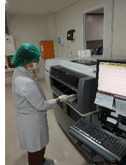
Memasukkan rak yang sudah berisi sampel pasien ke dalam alat dengan posisi barcode menghadap keluar
