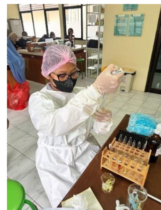
Memipet spesimen darah ke tabung reaksi yang sudah berisi reagen drabkin
