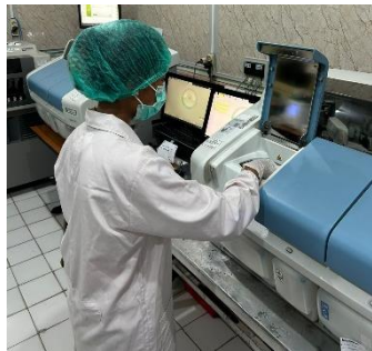
Memasukkan cuvet sampel kedalam alat spektrofotometer
