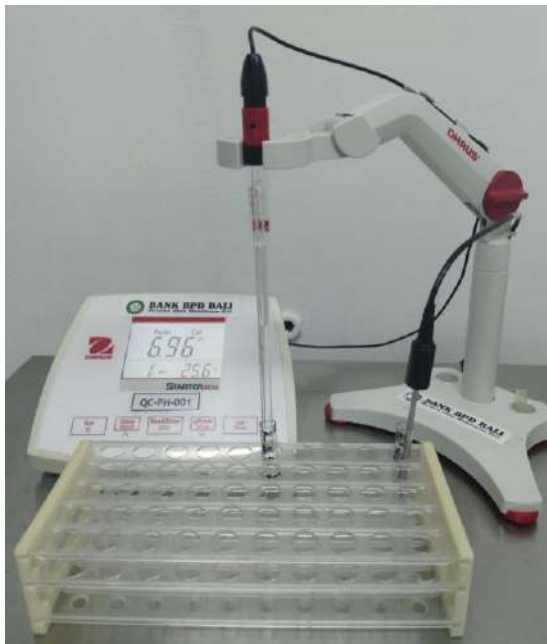
Gambar 11. Kalibrasi pH Meter dengan Buffer
