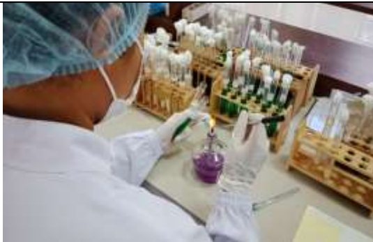
Gambar 9. Pengujian dengan metode MPN uji penegasan ( confirmative test )
