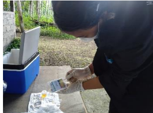
Pengukuran pH di lokasi
