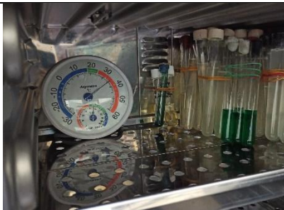
Gambar 17 Tabung media SIM, MR,VP,SC dimasukkan ke dalam inkubator dan diinkubasi selama 1 x 24 jam dengan suhu 37°C
