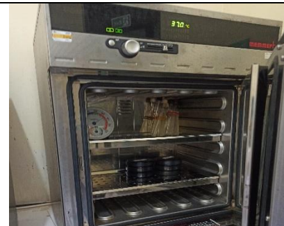
Gambar 10 Media EMBA dimasukkan ke dalam incubator dan diinkubasi selama 1 x 24 jam dengan suhu 37°C
