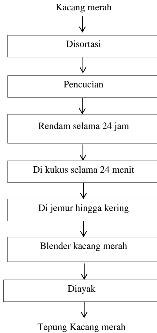
Gambar 4 Diagram Alir proses pembuatan tepung kacang merah
