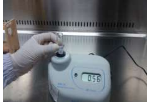
Pengukuran kekeruhan suspensi dengan standard 0,5 McFarland menggunakan densitometer
