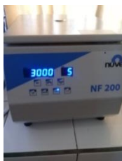
Proses centrifuge dengan kecepatan 3000 rpm selama 5 menit
