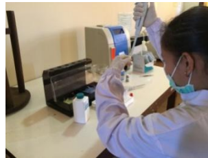
Proses pencampuran sampel serum dan reagen standar glukosa
