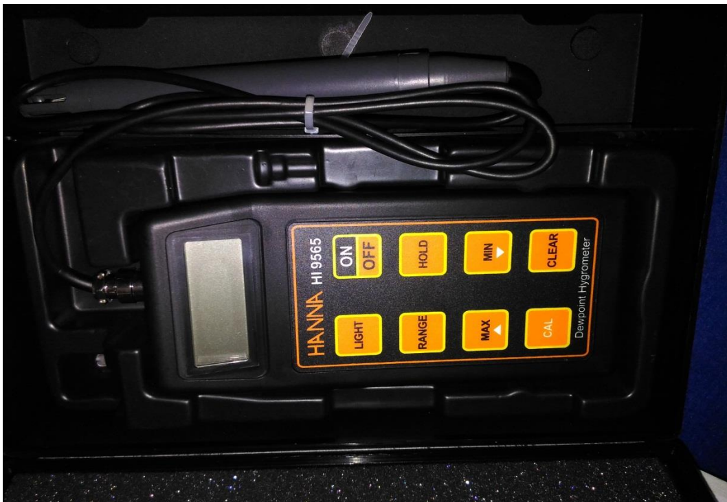
Alat Thermohygro Meter yang digunakan untuk mengukur suhu ruangan dan kelembaban udara
