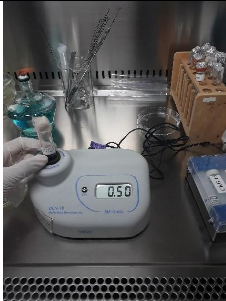
Pembuatan suspensi bakteri 0,5 McFarland bakteri Streptococcus pyogenes
