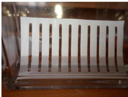
Proses uji dengan kromatografi terhadap sampel yang positif dari uji benang wool
