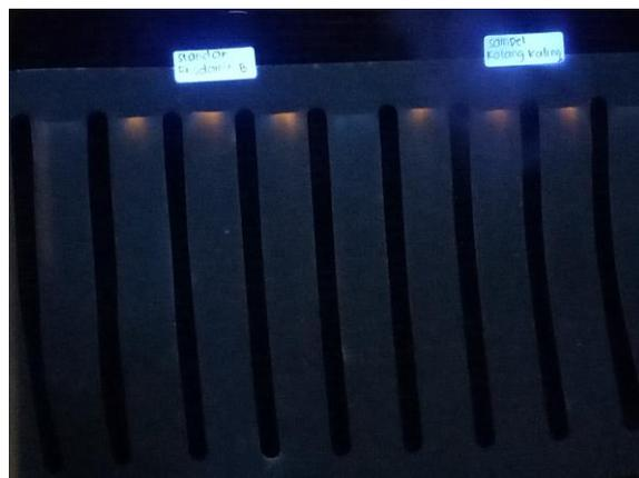
Penampakan noda standar rhodamin B dan sampel yang positif rhodamin B (kode P6) yang berpendar yang diamati menggunakan UV Chamber dengan panjang gelombang 366 nm
