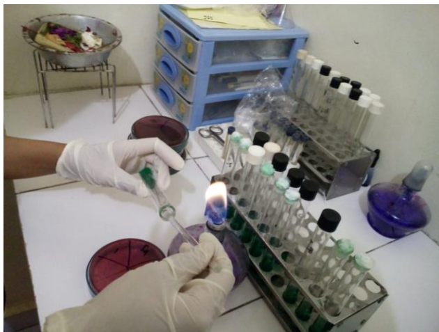
Persiapan larutan LB ( Lactosa Broth ) untuk uji bakteri coliform
