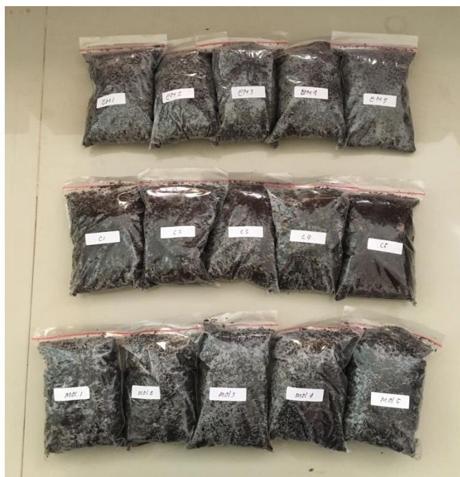
Sampel Kompos yang akan diperiksa kandungan unsur N,P,K di Laboratorium Kimia Jurusan Kesehatan Lingkungan
