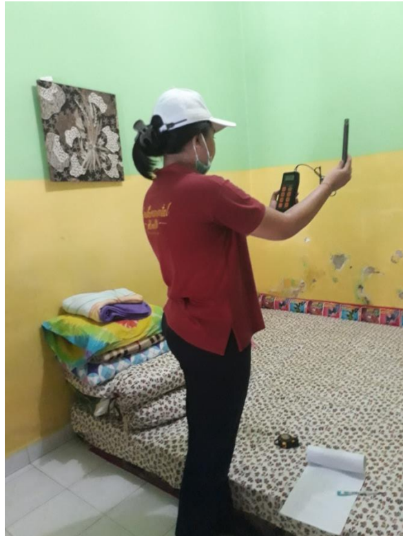
Gambar 5 Mengukur Kelembaban dan Suhu pada Ruangn Tempat Tidur Responden
