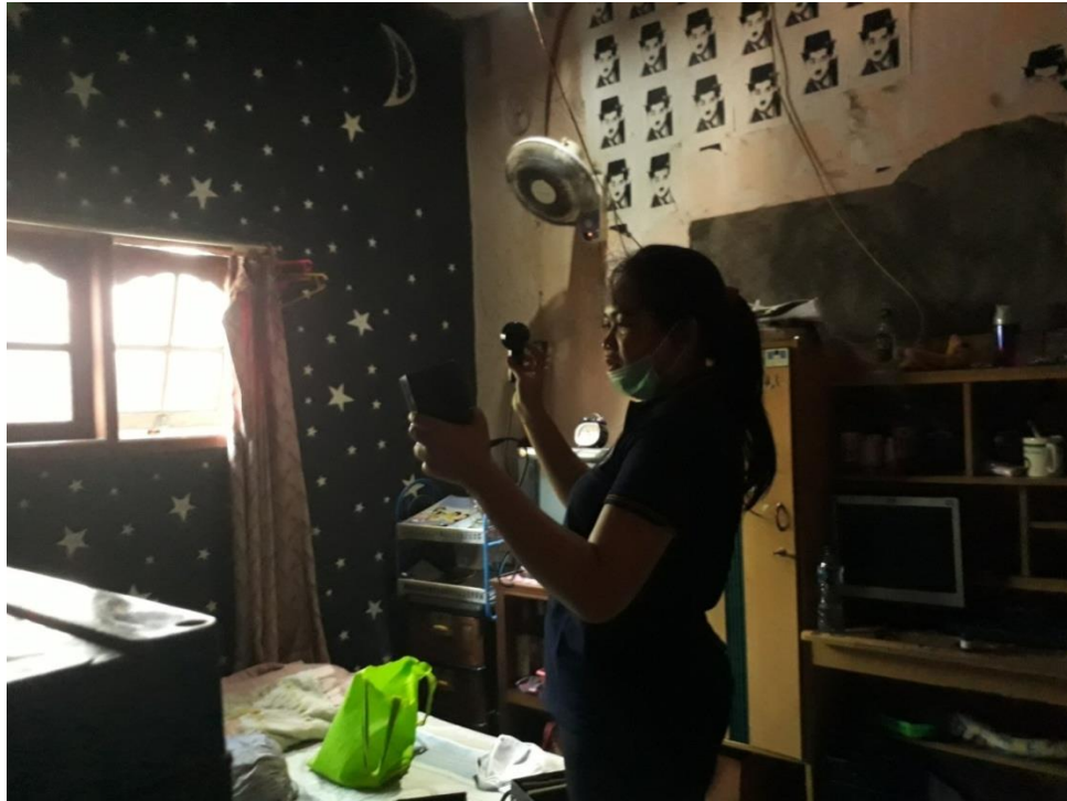
Gambar 3 Mengukur Pencahayaan Alami Rumah Responden
