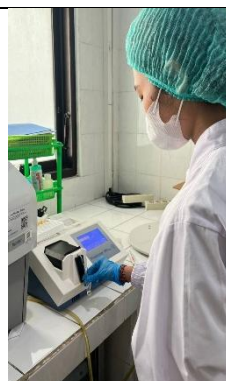
Pemeriksaan Bilirubin total dengan alat Speltrofotometer UV-Vis
