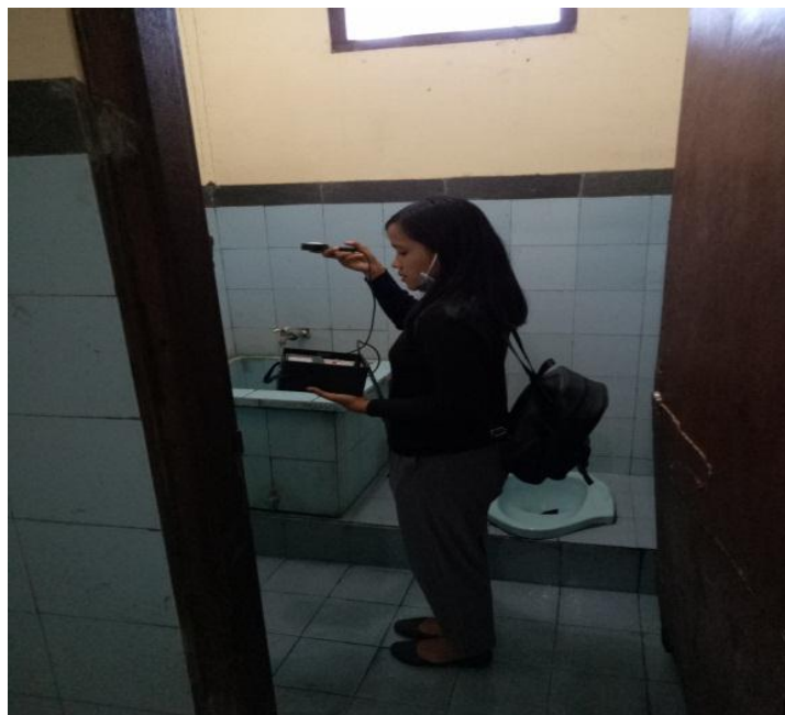
Pengukuran pencahayaan dengan menggunakan Lux Meter di areal kamar mandi/toilet pasar
