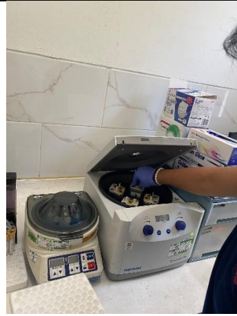
Proses pemutaran sampel dalam sentrifuge untuk mendapatkan serum darah
