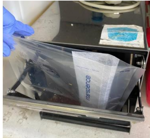
Proses homogenisasi sampel lawar plek menggunakan stomacher untuk memperoleh suspensi homogen
