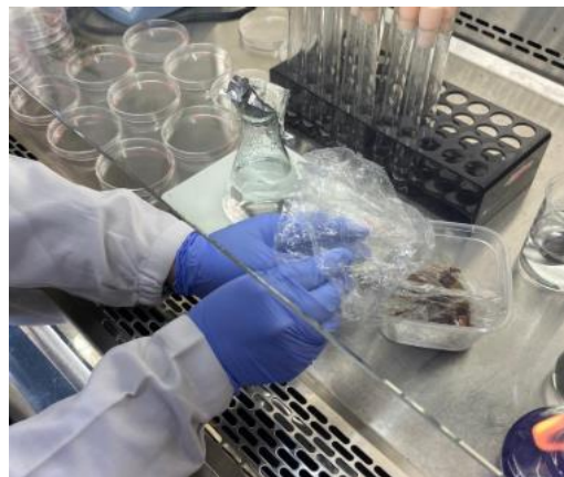
Proses pengambilan dan penimbangan sampel lawar plek menggunakan alat steril sebelum dilakukan uji Total Plate Count (TPC).
