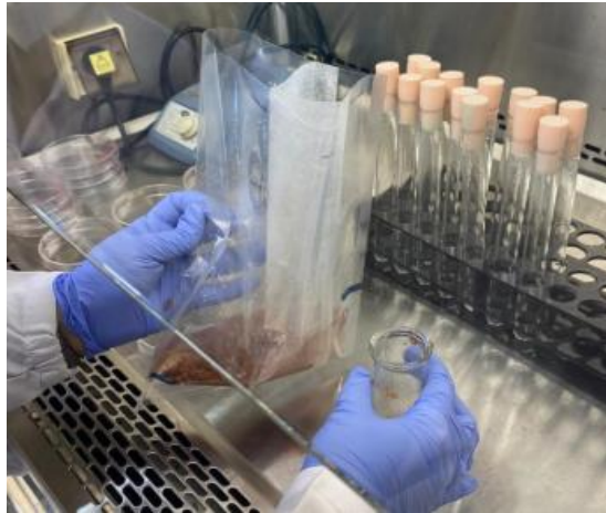
Pengambilan larutan hasil pengenceran sampel lawar plek ke stomacher bag untuk di homogenkan
