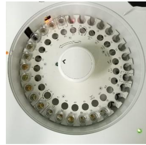
Melakukan pemeriksaan kadar glukosa darah puasa (GDP) pada alat Fotometer BiOLiS 30i Premium.
