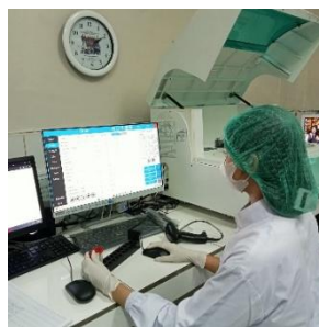
Melakukan pemeriksaan kadar glukosa darah puasa (GDP) pada alat Fotometer BiOLiS 30i Premium.
