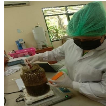
Penyaringan larutan setelah maserasi
