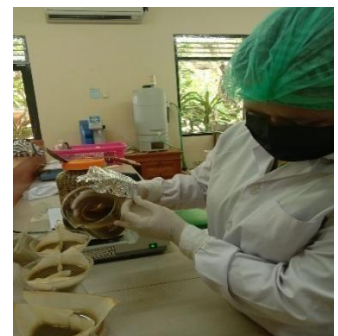
Penyaringan larutan setelah maserasi
