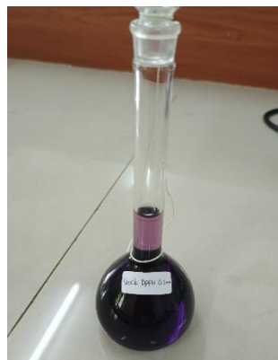
Pembuatan larutan stock DPPH 0,1 mM
