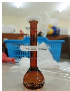
Pembuatan larutan induk sampel 500 ppm
