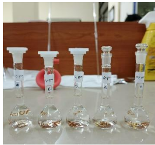
Pembuatan larutan seri konsentrasi
