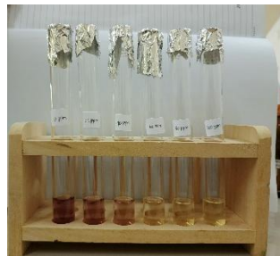
Pembuatan larutan uji untuk pengukuran absorbansi antioksidan
