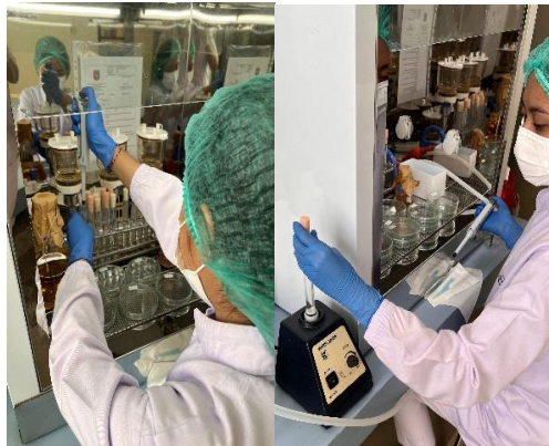
Gambar 13. Dilakukan pengenceran 10^{-1} sampai 10^{-5} pada tabung reaksi yang telah berisi 9 ml aquadest steril.
