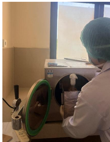
Gambar 9. Mensterilisasi media PCA, Erlenmeyer dan tabung reaksi yang berisi aquadest, serta blue tip pada autoklaf dengan suhu 121^{\circ}\text{C} selama 15 menit.
