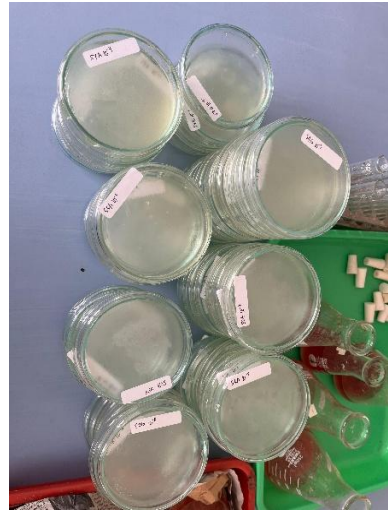
Gambar 16. Hasil inokulasi sampel ke cawan petri dengan media PCA.
