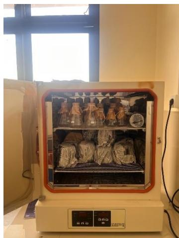
Gambar 8. Mensterililasi alat (Cawan Petri, Erlenmeyer, tabung reaksi) pada oven dengan suhu 180^{\circ}\text{C} selama 1,5 jam.
