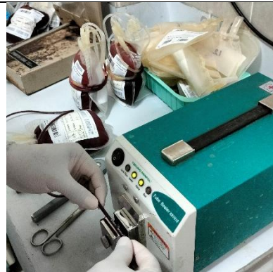
Proses seal pada blood bag tube sealer .
