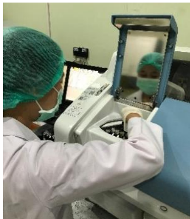
Memasukkan cuvet sampel ke dalam alat spetrofotometer
