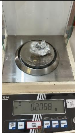
Penimbangan Massa Reagen untuk Pembuatan Larutan TCA 20% dan TBA 0,67%
