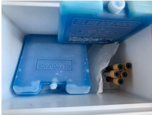
Sampel disimpan pada cool box berisi ice pack dan thermometer suhu 2-8°C
