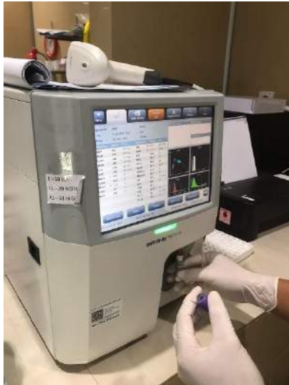
Pemeriksaan kadar hemoglobin dengan metode Kolorimetri Non-Cyanide SLS dengan alat Hematology analyzer
