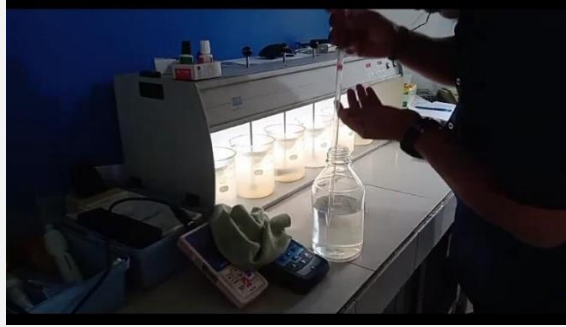
3. Proses penambahan koagulan pada air baku
