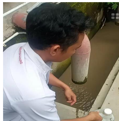
2. Pengambilan sampel untuk mengukur kekeruhan air Baku
