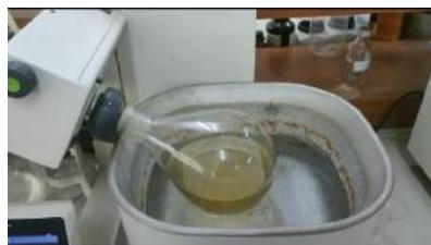
Proses evaporasi ekstrak etanol biji kepuh
