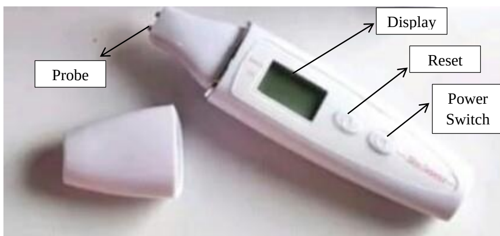
Gambar 2 Instrumen Pengukuran Kelembaban Kulit Kaki Pasien Diabetes Melitus Menggunakan Digital Skin Tester
