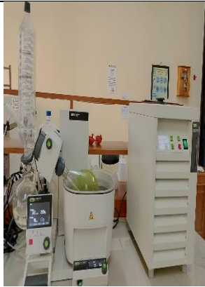
Proses pengentalan ekstrak dengan rotary evaporator
