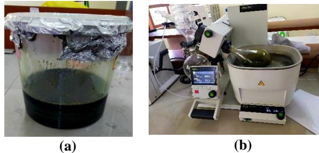
**Gambar 5. (a) Proses Maserasi, (b) Proses Pengentalan Ekstrak Batang Meniran Hijau Menggunakan *Rotary Evaporator***
