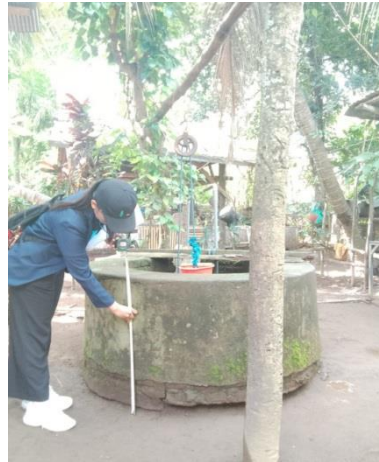
Mengukur tinggi bibir sumur
