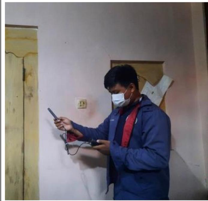
Pengukuran Kelembaban dengan Alat Hygrometer
