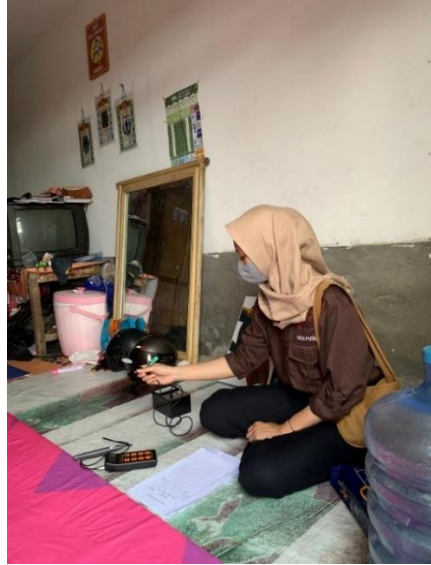
Gambar 11. Pengukuran Pencahayaan Menggunakan Alat Luxmeter
